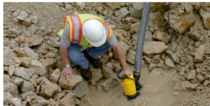
Trockenlaufsichere Elektrotauchpumpen: auch bei langem Schürfbetrieb dank integriertem Ölverteiler.
