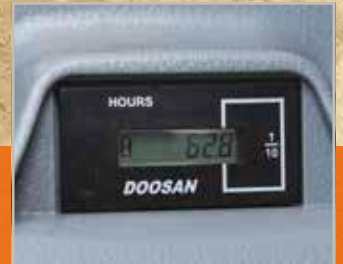
Betriebsstundenzähler (vom Boden aus ablesbar)
