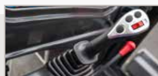
Proportional-Joystick mit Rändelradsteuerung
