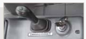
Planierschild-Schwimmstellung und Fahrtmoduswähler
