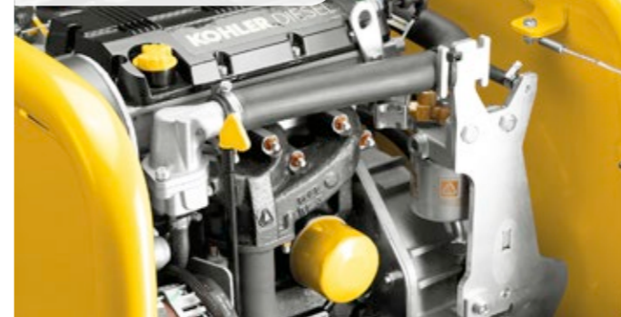
Der wassergekühlte Motor ist besonders leise im Betrieb.
