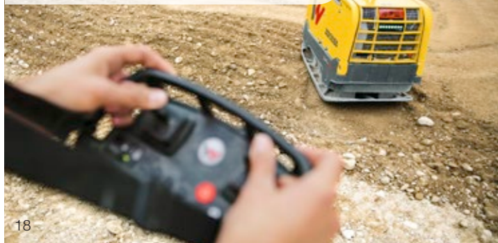
Fernsteuerung für hohen Bedienkomfort und feinfühliges stufenlose Steuerung.
