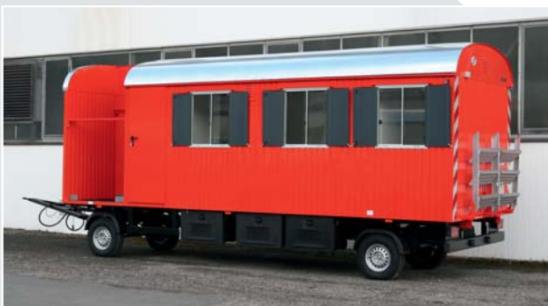
Weiro® RASANT Typ BM-D 24 S, 2-achsig, mit 7,0 m Aufbau­länge, lackiertem Fahrgestell, DIN-Zugöse und Druckluftbremse, Sonderlackierung, Treppenhalterung
