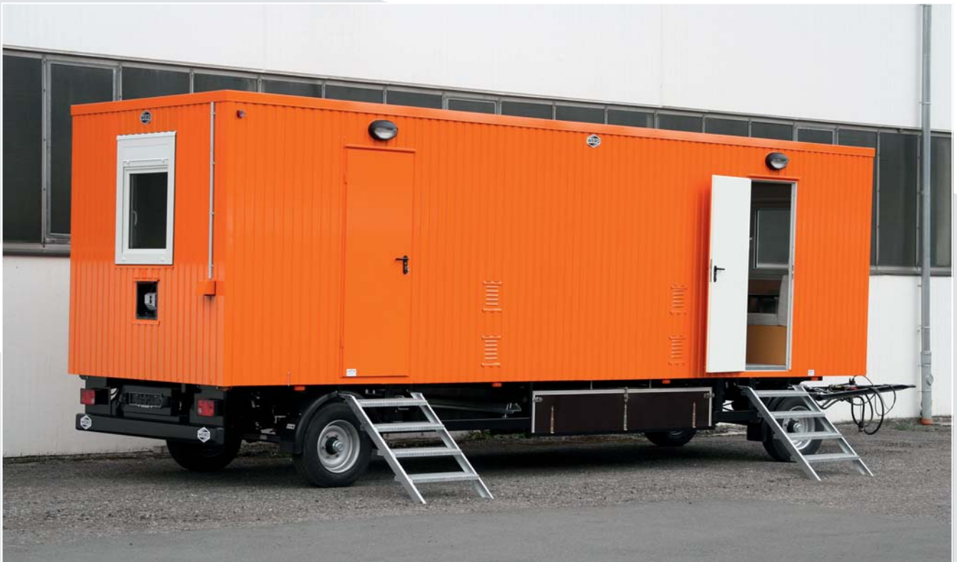
Weiro® RASANT Typ BM-E 26 S, Flachdachausführung, 2-achsig, mit 8,6 m Aufbau­länge, lackiertem Fahrgestell, DIN-Zugöse und Druckluftbremse mit ABS, Sonderlackierung, Gasinstallation, Gerätekasten unter dem Chassis
