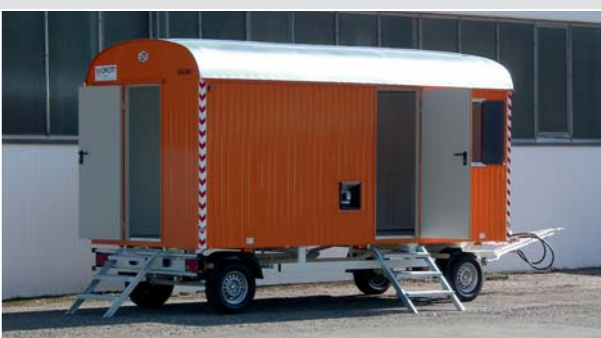
Weiro® RASANT Typ BM-B 22 S, 2-achsig, mit 5,0 m Aufbauhöhe, lackiertem Fahrgestell, DIN-Zugöse und Druckluftbremse, Sonderlackierung, Gasanlage
