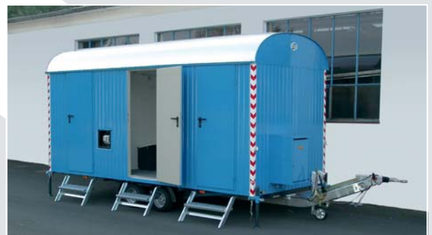
Weiro® RASANT Typ BME-E 22 ST, Tandemachse, mit 5,0 m Aufbau- länge, lackiertem Fahrgestell, höhenverstellbarer Aufauffeinrichtung mit DIN-Zugöse, Sonderlackierung, diverse Räume mit separater Tür
