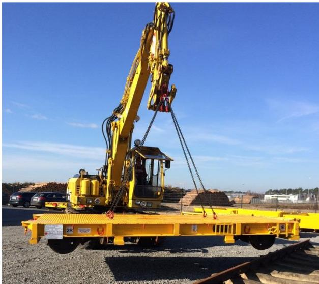
Der Gleisbauanhänger T5020 ist mit einem Zweiwege-Bagger ein- und aussetzbar sowie mit einem Standard-LKW zu transportieren.
