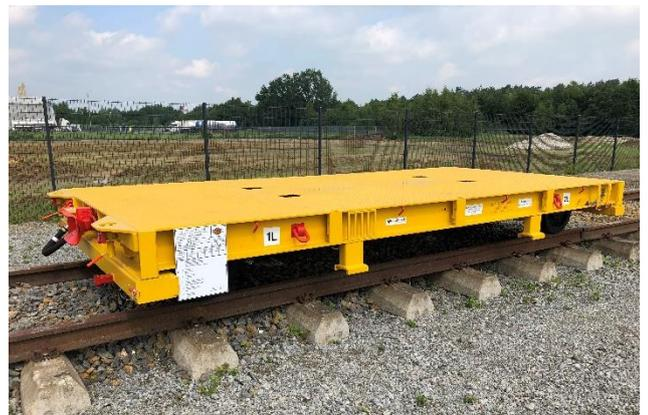
Es können bis zu 4 baugleiche Anhänger im Zugverband mit einem ZW-Bagger geschleppt werden.
