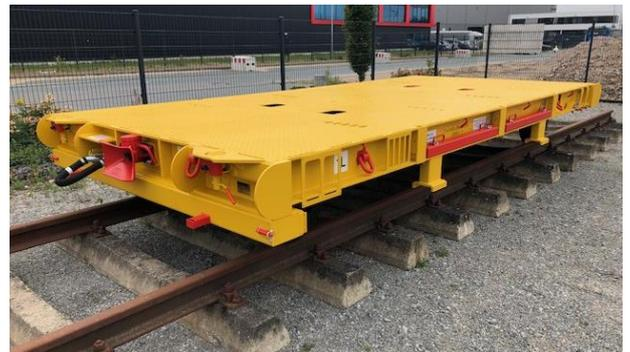
Der T5025 FB ist optimal zum Transport von Gleisbaumaschinen ausgestattet.
