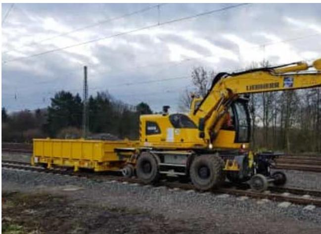
Der Gleisbauanhänger T5025 FB ist mit einem Zweiwege-Bagger ein- und aussetzbar sowie mit einem Standard-LKW zu transportieren.
