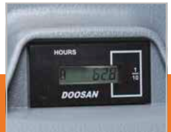
Betriebsstundenzähler (vom Boden aus ablesbar)
