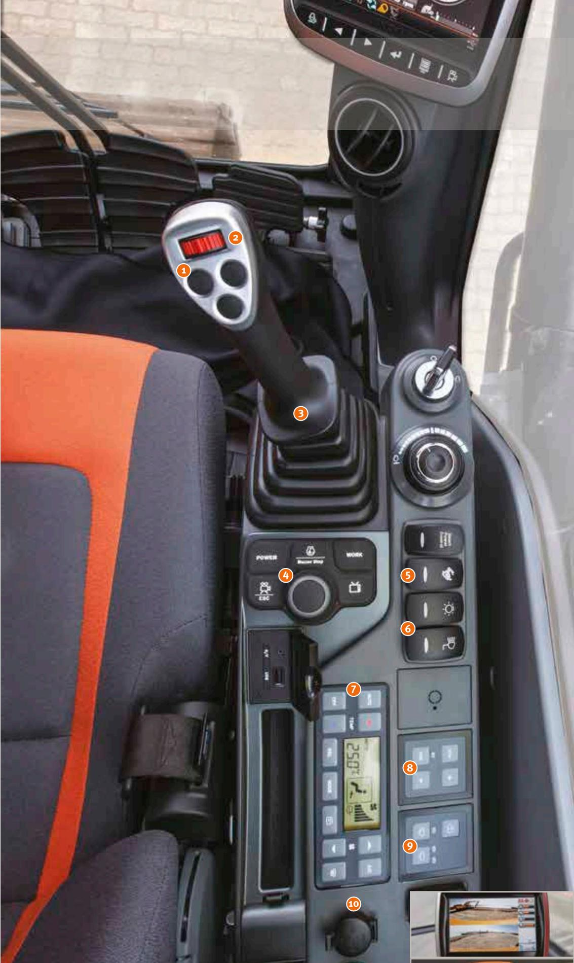
**Einfache Steuerung:** Der exklusive Jog-Shuttle-Schalter von Doosan ermöglicht die einfache und präzise Steuerung aller Maschinenfunktionen.
